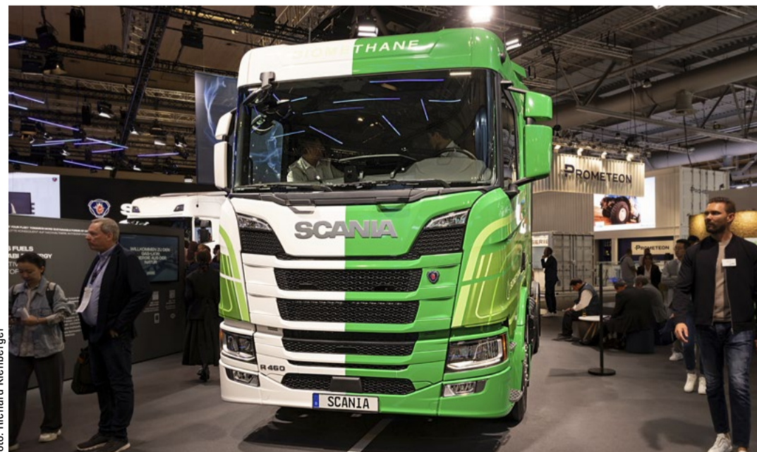
Der zweifarbige Scania R 460 mit Gasmotor kann sowohl mit komprimiertem Biogas (CBG) als auch mit verflüssigtem Biogas (LBG) versorgt werden. Damit kann er an jeder Gas-Tankstelle tanken und die CO 2 -Emissionen laut Hersteller um bis zu 90 Prozent reduzieren.
