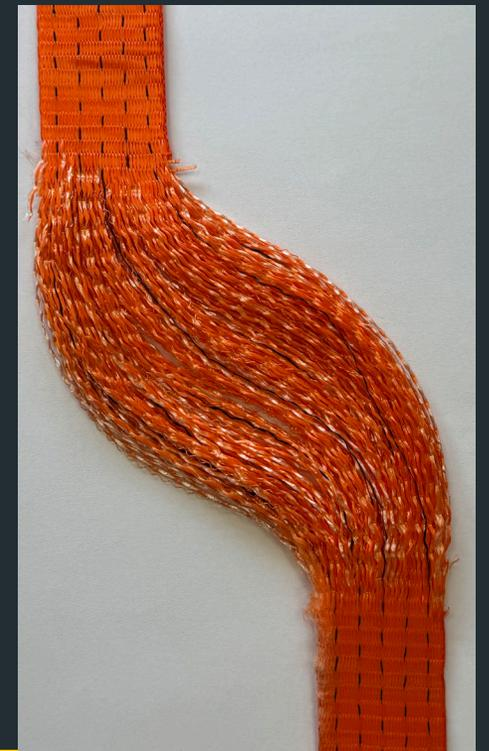
Die in Längsrichtung verlaufenden Kettfäden übernehmen die tragende Funktion
