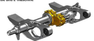
CAD - elektrische Achse, Getriebe und E-Maschine
