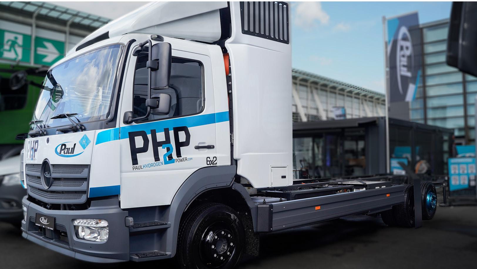
Paul PH2P® Truck 6x2 mit zusätzlicher luftgefederter Nachlauf-Lenkachse mit bis zu 22 Tonnen Gesamtgewicht auf IAA 2024
