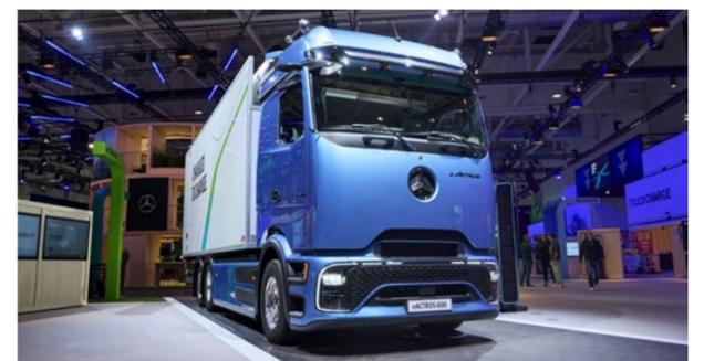
Mit neuem Gesicht in die Zukunft: Der schwere batterieelektrische eActros 600 (oben und rechts) geht Ende November in die Serienproduktion. Seine E-Achse bringt es auf 400 kW, die LFP-Akkupakete ermöglichen eine Reichweite von 500 Kilometern.
