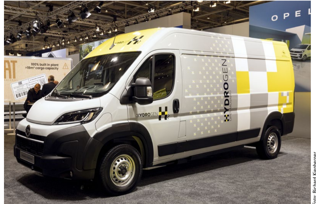
Trotz seines Brennstoffzellenantriebs mit Plug-in-Akku verfügt der Movano Hydrogen über 1.370 Kilo Nutzlast.
