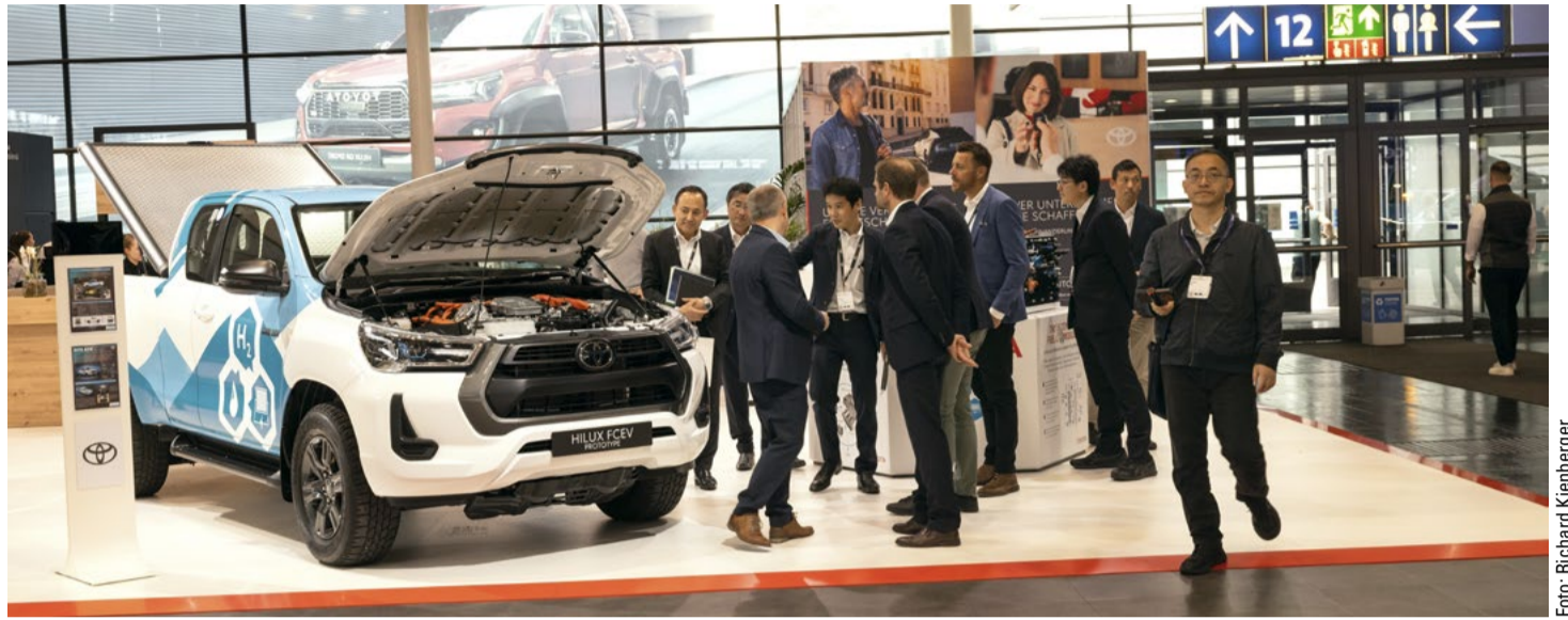
Der Pick-up Toyota Hilux erhält im kommenden Jahr erstmals ein 48 V-Mild-Hybrid-System. Hier steht er bereits auf der IAA TRANSPORTATION.
